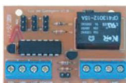
Permite que ao acionar o portão, uma lâmpada seja acesa e o tempo controlado entre 0,3s, 1min, 2min, 3min, 4min e 5 min, bastando mudar o jumper para o tempo desejado. Após esse tempo a luz se desliga automaticamente.
