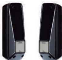
Barreira infravermelha de até 20 metros que ao ser interrompida, automaticamente corta o funcionamento do automatizador. Possibilidade de uso sem fio no transmissor com uso de bateria. Placa direcionável para uma instalação precisa. Necessário o uso desse dispositivo para todos os automatizadores, em acordo com a portaria inmetro 371 / 2009.
