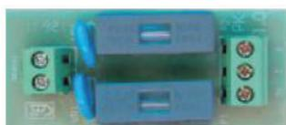
Placa de proteção contra oscilação de tensão. Em caso de variação brusca na rede elétrica os componentes se rompem evitando que a sobrecarga queime a central de comando. Ligue sua placa PK antes da central de comando usando a saída da rede.
