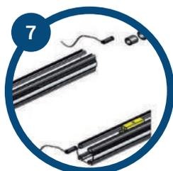
7 Coloque os reed's na canaleta do automatizador, parafuse o limitador mecânico. Para instalação eletrônica consulte a seção centrais de comando.
